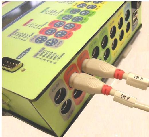
relatif, en poussant le connecteur jusqu'au fond, de façon à ce que le plastique du connecteur touche le terminal TMF. Faire attention à l'orientation des connecteurs sans en forcer l'insertion et sans endommager les connecteurs.
