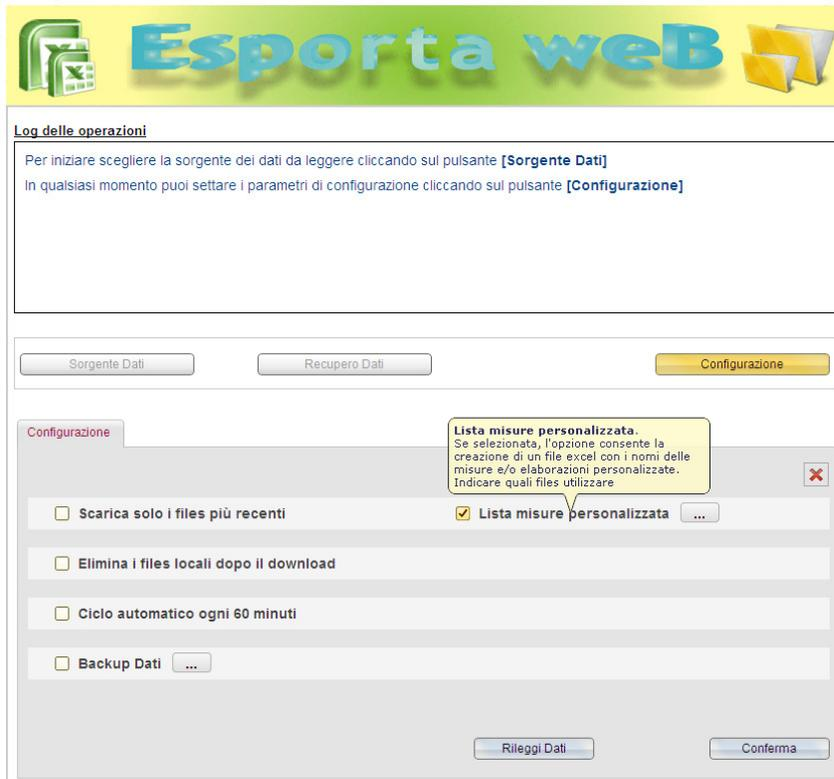
Appuyer sur la touche Configuration, une deuxième partie de la fenêtre s'ouvre dans la partie inférieure qui permet d'habiller/désactiver certaines options décrites ci-après. Pour comprendre la signification de chaque option, il suffit de se placer au-dessus du texte avec la souris, une info-bulle apparaît avec toutes les informations nécessaires pour l'utilisation de la fonction.
